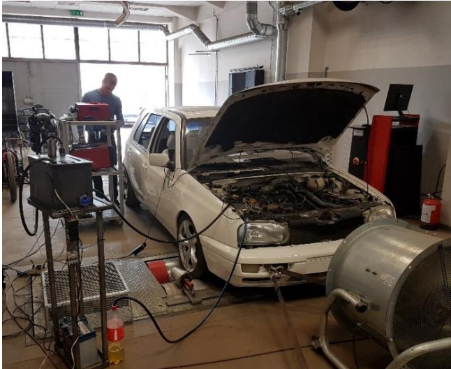
4 pav. Variklio energetinių rodiklių matavimas naudojant lengvųjų automobilių traukos stendą „CARTEC LPS 2510“
