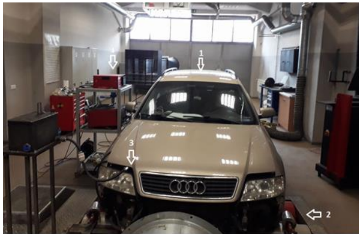
1 pav. Kompiuterizuotą lengvųjų automobilių traukos stendą CARTEC LPS 2510. 1 – automobilis AUDI A6 C5; 2 – kompiuterizuotą lengvųjų automobilių traukos stendą CARTEC LPS 2510; 3 – degalų sąnaudų matuoklis; 4 – išmetamųjų dujų analizatorius TECNOTEST
