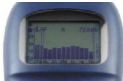
Matuojamų oktavų juostos „CEL–440“ ekrane Measured octave bands on the CEL-440 screen
