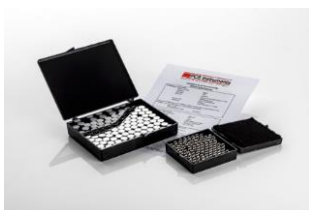
3 pav. Rutulys guolių plieno E-52100 Fig. 3. Bearing steel ball E-52100
