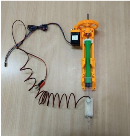
2 pav. Papildomas spausdinimo šokoladu modulis 3D spausdintuvui
